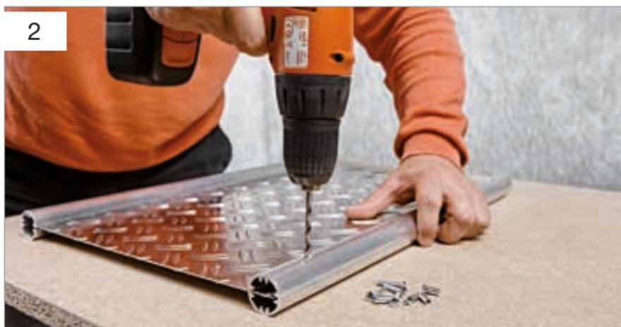
In den Längsschlitz des Multitubes stecken Sie Ihr Blech so weit ein, bis es in die gegenüberliegende Zentrierungs- und Fixiergrinne einrastet. Dies wiederholen Sie, sofern Sie eine Rampe herstellen wollen, auf der anderen Blechseite.
