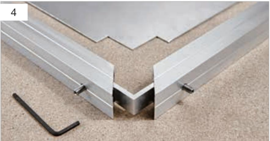
Die Multitube-Rohre werden durch die Eckwinkel wie folgt verbunden: Im Abstand von ca. 30 mm vom Rohrende bringen Sie auf der Kennrille jeweils eine 4,0-mm-Kernbohrung ein. Danach schneiden Sie M5-Gewinde. Jetzt stecken Sie die Multitube-Rohre mit dem Blech und den passenden Eckwinkeln (Führungskanäle im Profil) zusammen. Abschließend die Gewindestifte so weit einschrauben, bis sie fest auf die Eckwinkel drücken.
