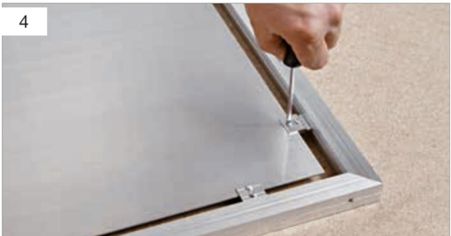
Diese erste Verschraubung erfolgt im offenen, d. h. durchgängigen Loch (auf der dem Multitube zugewandten Seite). Die passenden Aluminium-Hülsenmuttern und -Schrauben sind in unserem Sortiment erhältlich, Art.-Nr. 30420 (S. 11).
