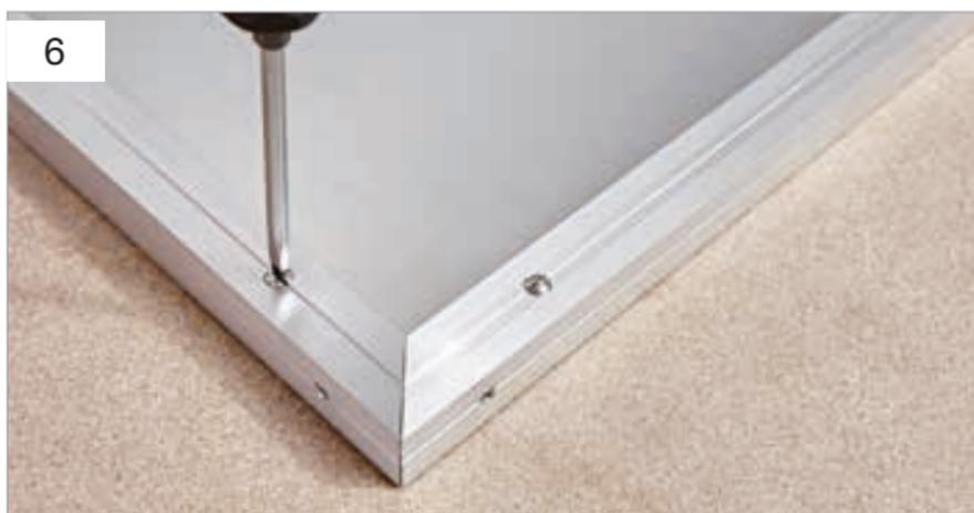
Um das Blech mit den Multitubes zu verspannen, verwenden Sie die Hülsenmuttern und Schrauben und gehen wie auf den Seiten 18 und 19 beschrieben vor.
