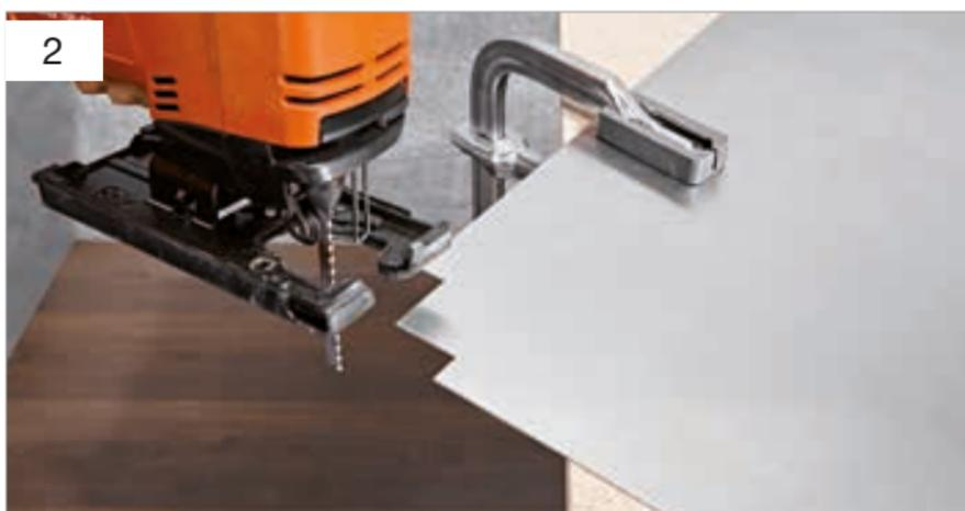
Das einzufassende Blech müssen Sie zunächst an allen vier Ecken mit einer Stichsäge ausklinken. Unsere Ausklinkschablone, die diesen Arbeitsschritt enorm erleichtert, ist in jedem Eckwinkelbeutel enthalten.
