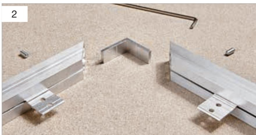
Die Abhängegleiter werden seitengleich in den Längsschlitz der Multitube-Rohre eingefädelt. Danach werden die Multitubes mithilfe der Eckwinkel zu einem Rahmen zusammengesteckt und verschraubt (siehe vorstehende Anleitung Rahmenvariante 1).
