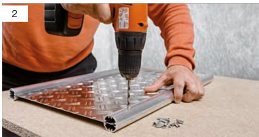
Nella fessura longitudinale di Multitube, inserire la lamiera fino a quando non scatta in posizione nel relativo canale di centraggio e di fissaggio. Se si vuole realizzare una rampa, ripetere l'operazione sull'altro lato della lamiera.
