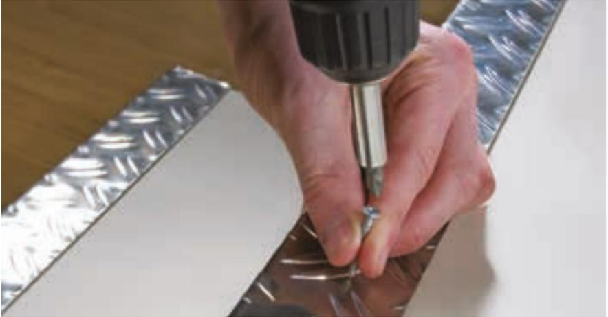
El mecanizado de las chapas estriadas y perfiles o esquinas para cajas se realiza mediante remaches, tornillos, soldadura o pegado, dependiendo de la aplicación.
