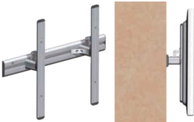
On voit ici un support mural pour écran plat. Le profilé **coaxis** a ici été assemblé avec un profilé colonne **coaxis** et une charnière articulée **coaxis**. Il est ainsi possible de pivoter l'écran vers le haut. L'écran peut cependant également être déplacé vers le haut et le bas, ainsi que vers la gauche et la droite. La charnière articulée coaxiale a été utilisée ici.
