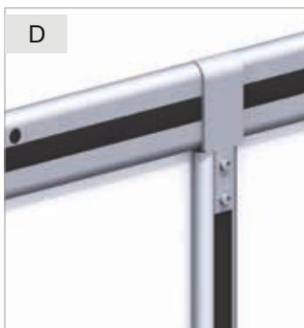
Consejo: Si mediante el montaje del perfil **coaxis**® ya no es posible encajar las tuercas cuadradas, con una perforación de 9,5 mm en la ranura, posteriormente se puede lograr un acceso directo para otro kit de montaje para ganchos.
